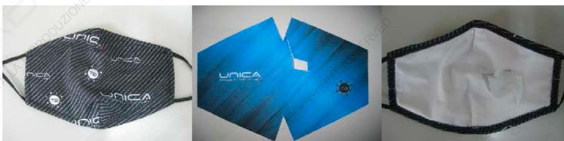
**FIG.1** Esempio di campioni ricevuti: a sinistra una mascherina completa, al centro il campione non trattato (solo parte colorata della mascherina), in cui si può vedere la zona in cui è stato ricavato il provino analizzato, a destra il campione da cui è stato ricavato il provino nella parte interna in cotone della mascherina (si vede la parte tagliata).
